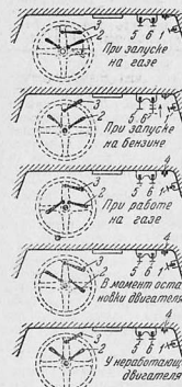
Рис. 3. Схемы сравнительных положений органов управления двигателем автомобиля ГАЗ-42 (наименование обозначений см. на рис. 1)
