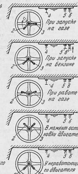
Рис. 4. Схемы сравнительных положений органов управления двигателем автомобиля ЗИС-21 первых выпусков (наименование обозначений см. на рис. 2)
